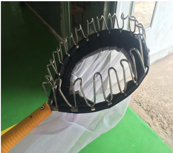
รูปที่ 6 อุปกรณ์ช่วยสอยมะม่วง V.2
