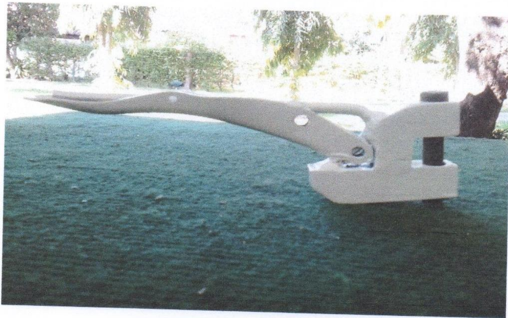
รูปที่ 15 อุปกรณ์ช่วยตีกับสายไฟฟ้า
