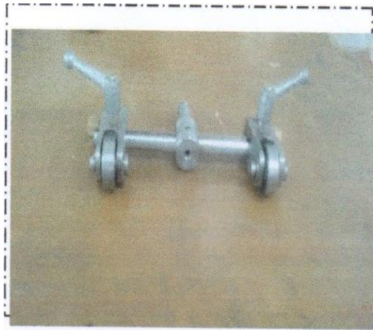
รูปที่ 11 อุปกรณ์ตั้งศูนย์ชิ้นงานบนเครื่องกลึง เครื่องกัด และ เครื่องเจาะ
